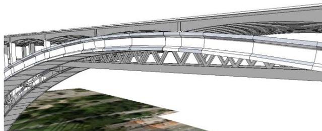
Fig.51 – Solução estrutural em tabuleiro intermediário (solução não adoptada)
