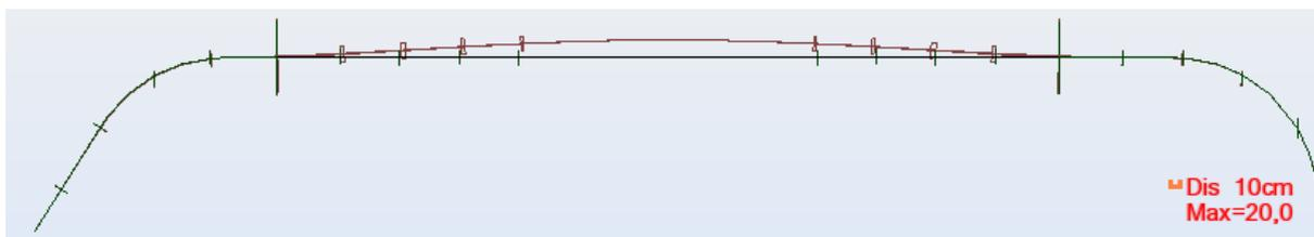
Fig.106 – Vista em planta do diagrama de momentos flectores em torno de y na combinação 6
