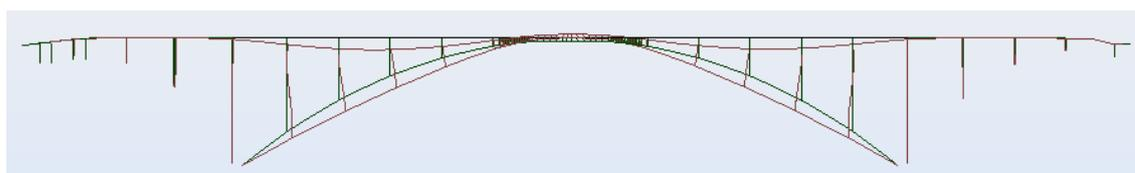
Fig.6 – Vista em alçado da deformada sob acção permanente
