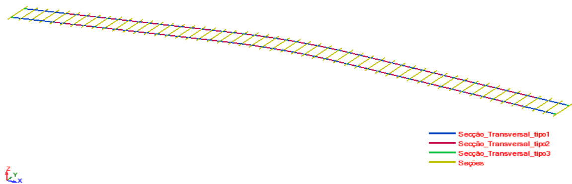
Fig. 77 – Modelo de cálculo longitudinal do tabuleiro
